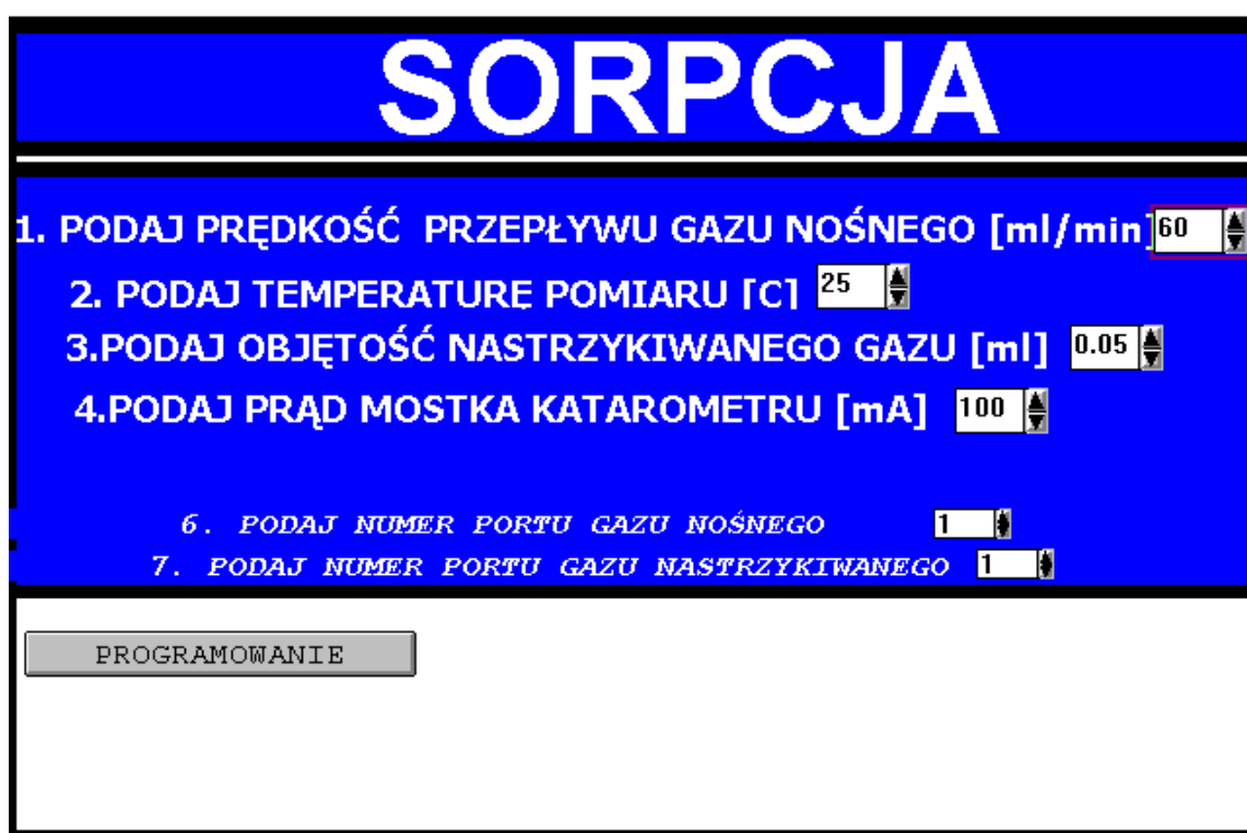
Rys. 6. Ekran umożliwiający programowanie procesu sorpcji
